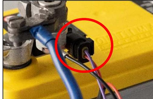
Verbinden Sie nun den roten Ringkontakt mit dem positiven Pol Ihrer 12V-Batterie. Klemmen Sie den Ringkontakt dafür einfach unter die Mutter, welche dazu da ist, das Stromkabel Ihres Fahrzeuges an dem positiven Pol der Batterie festzuklemmen.
