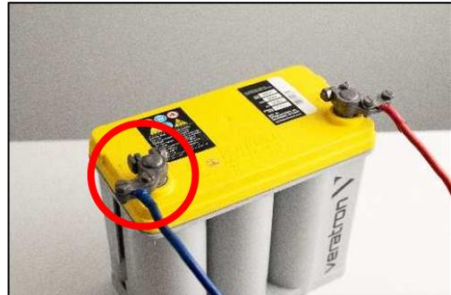
Befestigen Sie als erstes das Massekabel des mitgelieferten Kabelbaumes an dem Masseanschlussbolzen des Batteriesensors. Benutzen Sie den Batteriepoladapter, um den vorgesehenen Ringkontakt zu befestigen. Stellen Sie sicher, dass der Sensor nicht beschädigt wird, wenn Sie die Schrauben anziehen. (Beachten Sie die Bemerkung weiter unten.)
