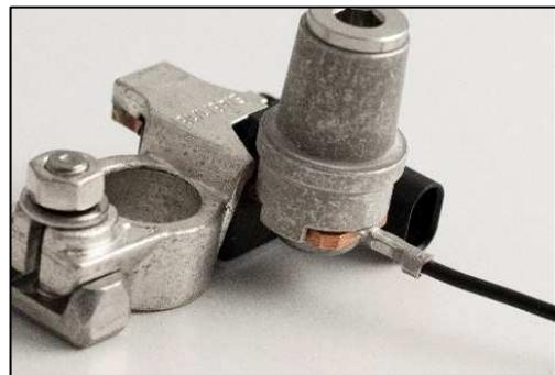
Befestigen Sie nun das Massekabel des Fahrzeuges (, welches zuvor direkt an dem negativen Pol der Batterie angeschlossen war,) an den Batteriepoladapter auf dem IBS.
